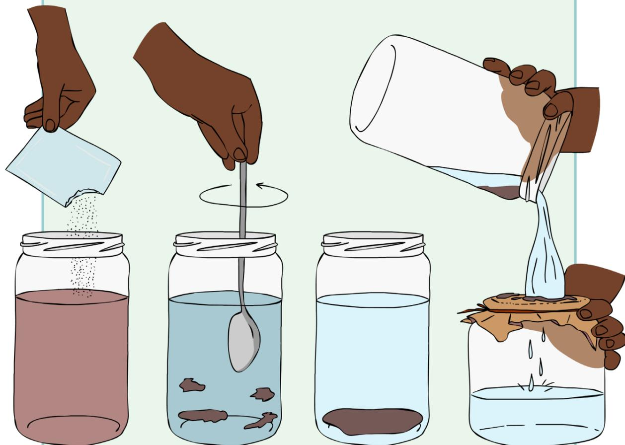
**Cloración:** para agua con baja turbidez, se mezclan una solución de hipoclorito o tabletas de cloro con agua. Es eficaz contra virus y bacterias, pero tiene un efecto limitado con los protozoos. Es muy fácil de usar y de bajo costo, pero la cloración también afecta el sabor y el olor del agua.
